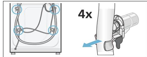
2. Выверните и удалите 4 винта транспортировочных креплений при помощи гаечного ключа SW13. Удалите втулки. При этом извлеките сетевой кабель из держателей.
