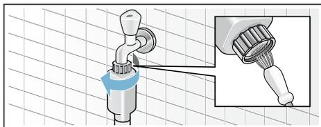
2. Для стандартных моделей и моделей с системой «Aqua-Secure» очистите сетчатый фильтр на задней стенке прибора: Отсоедините шланг от задней стенки прибора. Извлеките фильтр с помощью плоскогубцев и прочистите его.
