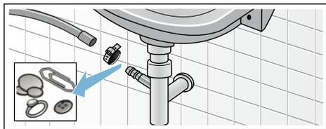
4. Подсоедините сливной шланг и зафиксируйте место соединения шланговым хомутом.
