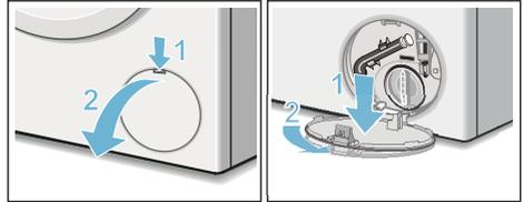
4. Выньте сливной шланг с держателя. Снимите крышку, слейте раствор моющего средства в соответствующую ёмкость. Установите закрывающую крышку на место. Вставьте сливной шланг в держатель.
